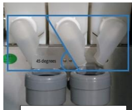
Сопло отсека для сыпучих ингредиентов под углом 45°
